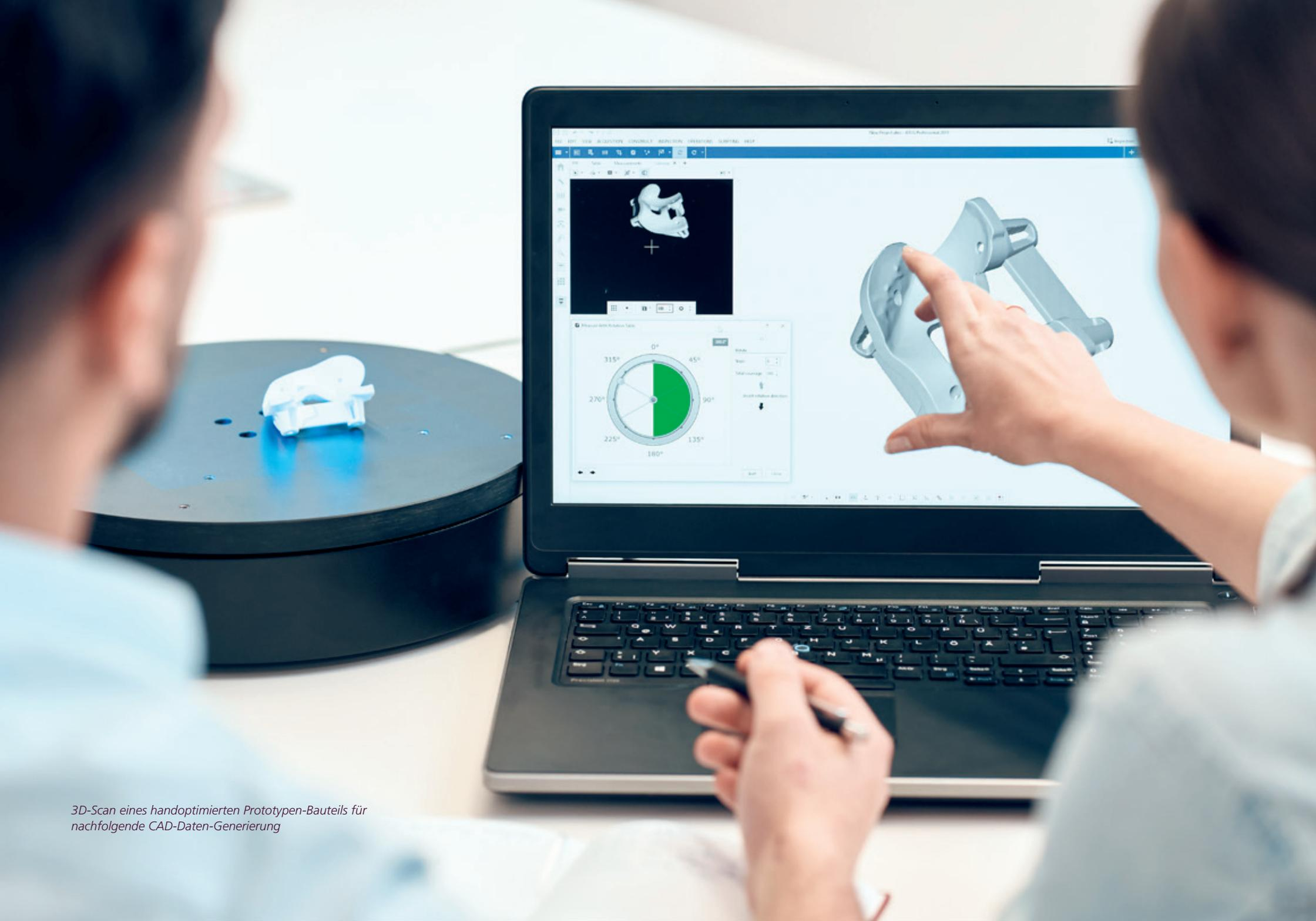
*3D-Scan eines handoptimierten Prototypen-Bauteils für nachfolgende CAD-Daten-Generierung*
